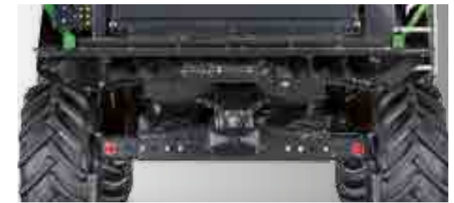
Robustní zadní náprava s nastavitelným rozchodem a s možností vybavení systémem pohonu zadních kol 4WD s exkluzivním DEUTZ-FAHR protiprokluzovým systémem
