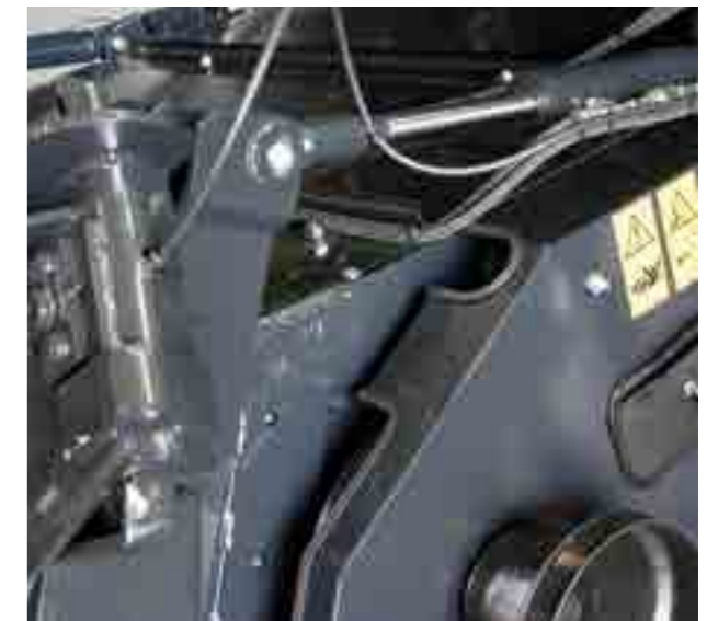
Elektrohydraulické nastavení úhlu sečení je standardem u všech modelů se systémem BALANCE pro optimální pozici žací lišty vzhledem ke směru pohybu stroje a měnícímu se sklonu terénu
