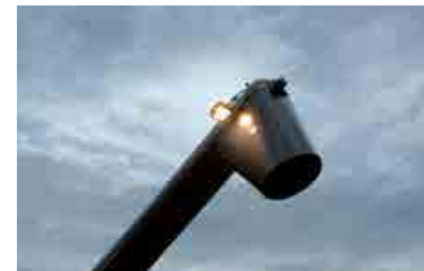
Světla na konci vyprazdňovací roury umožňují kontrolu kvality zrna i v nočních hodinách
