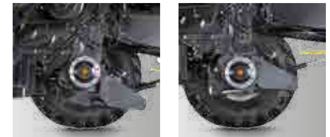
Nápravy BALANCE s nosností až 25 t umožňují stroji pracovat i v nejextrémnějších podmínkách, jejich robustnost zaručuje dlouhou životnost a především bezpečnost za každých podmínek
