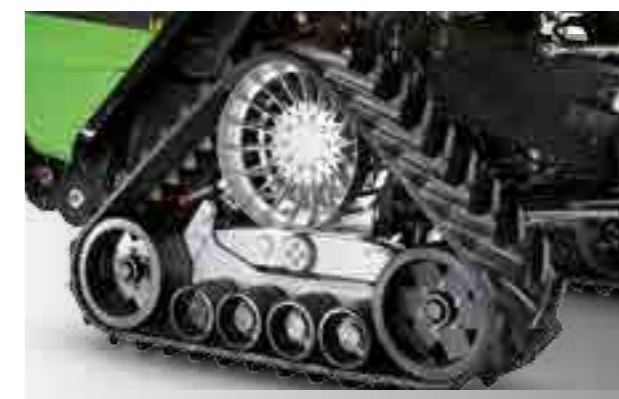
30" systém gumových pásů pro minimální ztuhnutí půdy a zvýšení újezdnosti i při extrémních podmínkách
