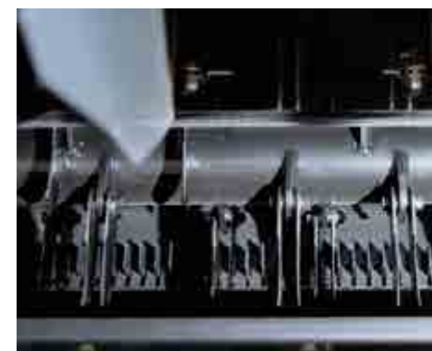
Metač plev s novým dopravníkem a kanály přivádějícími plevy přímo do čtyřlopatkových rotorů
