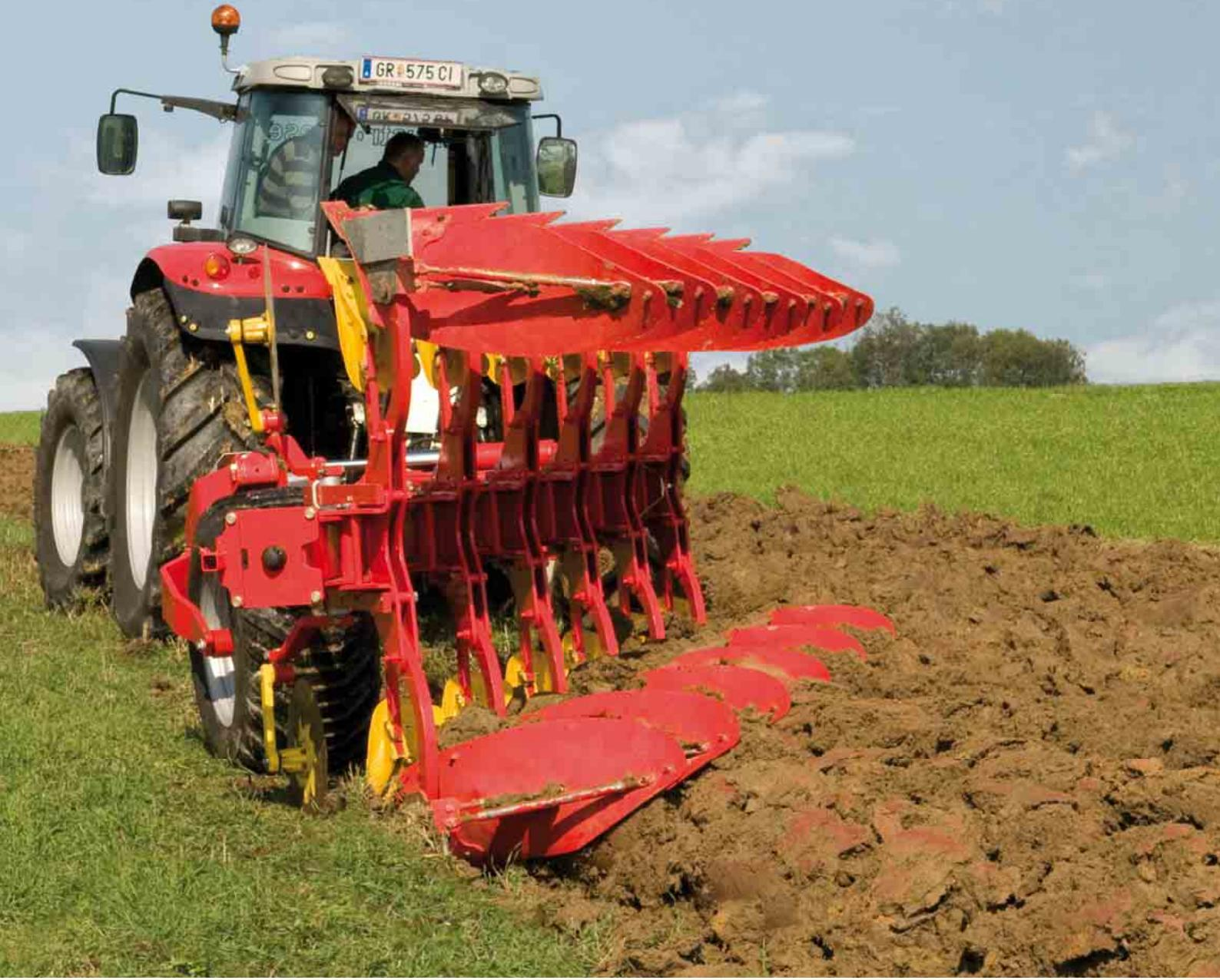
Dočaženie zadnej nápravy traktora pomocou systému **TRACTION CONTROL**
