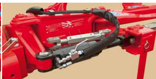
Hydraulický válec pro výkyv rámu
