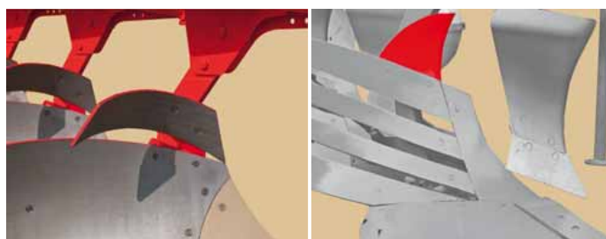
Zahrnovací límce – se vyznačují dobrou průchodností a zaklopením rostlinných zbytků.
