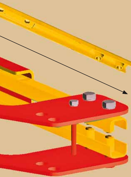
Výztuhy v oblastech největšího zatížení rámu
